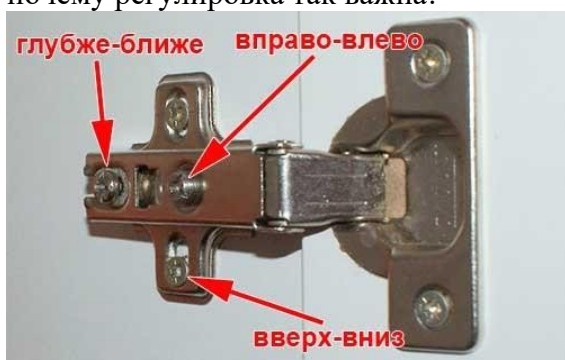
Рис. Стандартная схема регулировка петель с доводчиком
