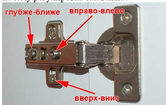
Рис. Стандартная схема регулировка петель с доводчиком
